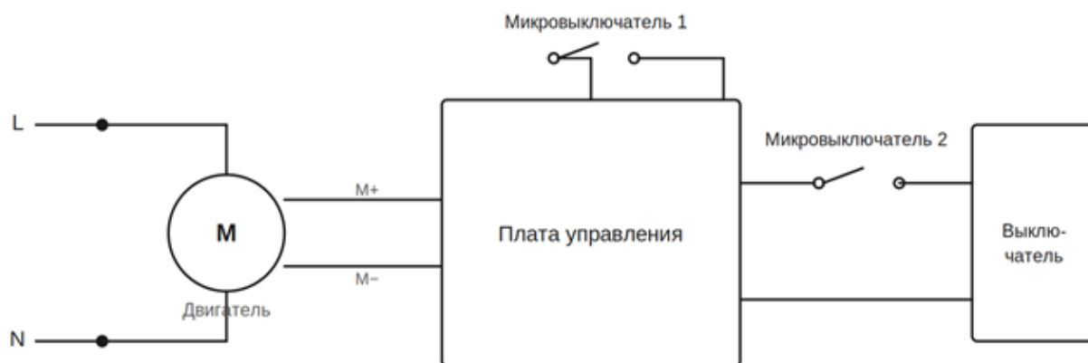
Рис. 1. Функциональная схема цепи блокировки: питание подается на двигатель только при замкнутых микровыключателях 1 и 2 и включенном выключателе.
